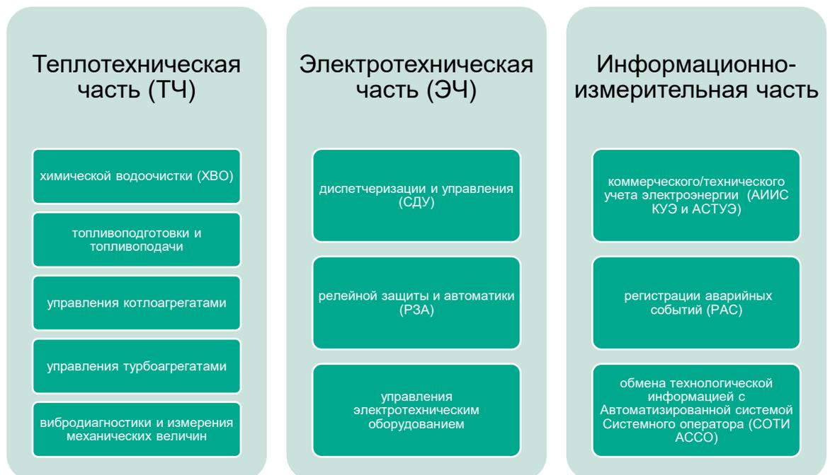
Рисунок 2. Функциональные подсистемы АСУ ТП типового объекта теплоэлектрогенерации
