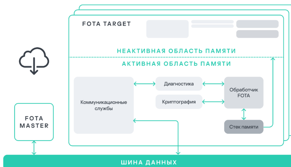
Рис. 2. Схема обновления FOTA Master – FOTA Target
