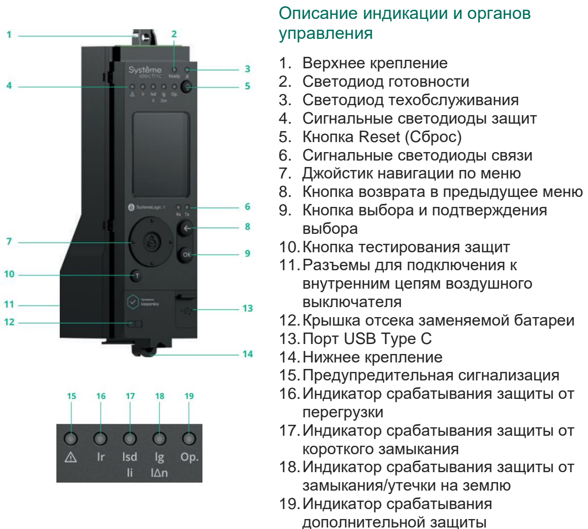
Рис. 1. Общий вид блока управления электронного SystemeLogic X для силовых автоматических выключателей SystemePact
